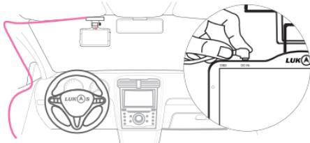
6 설치 완료 후 차량의 시동이 걸린 상태에서 전원 스위치를(ACC 또는 ON) 켜주시기 바랍니다. 정상적으로 동작하는지 제품의 LCD 화면을 통해 확인 바랍니다.
